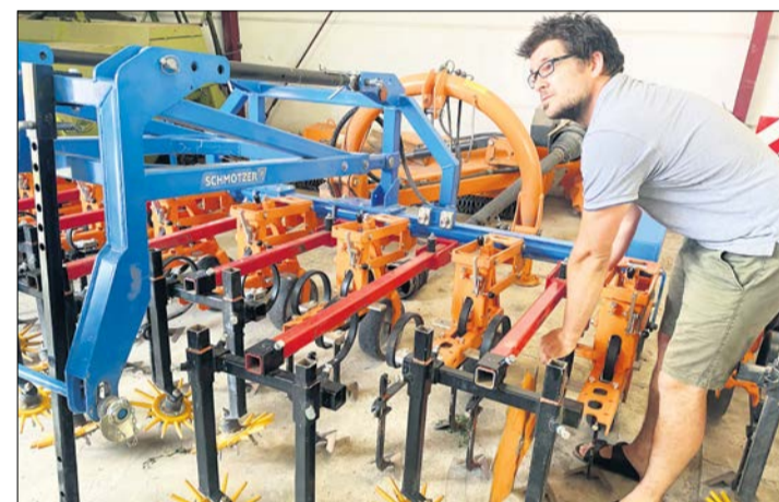
Das Hackgerät setzt er zwei- bis dreimal im Sojaanbau ein. Beim ersten Mal mit Schutzscheiben.
